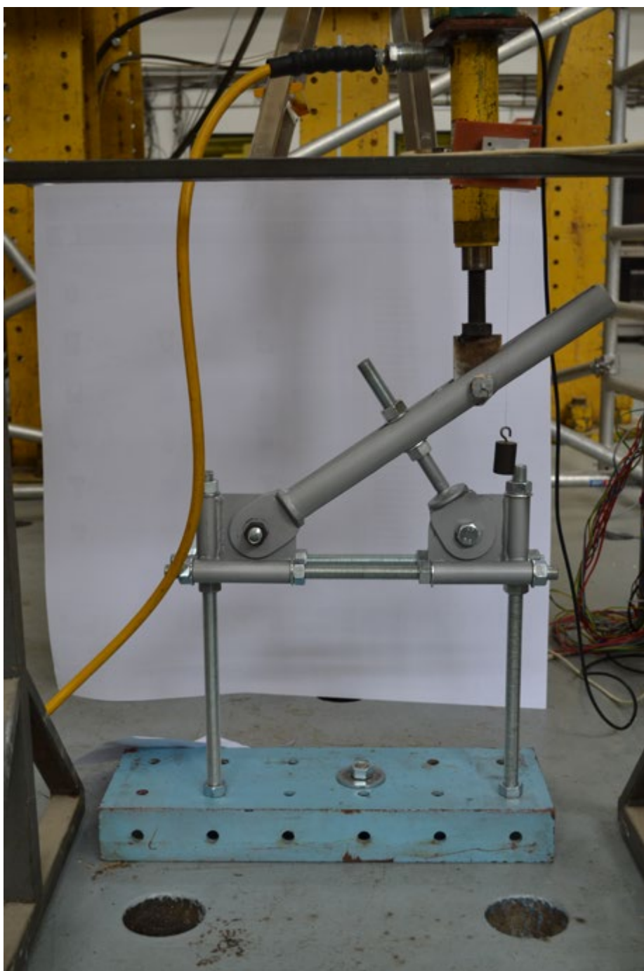
Obr. 2 Zkouška pákové kotvy
