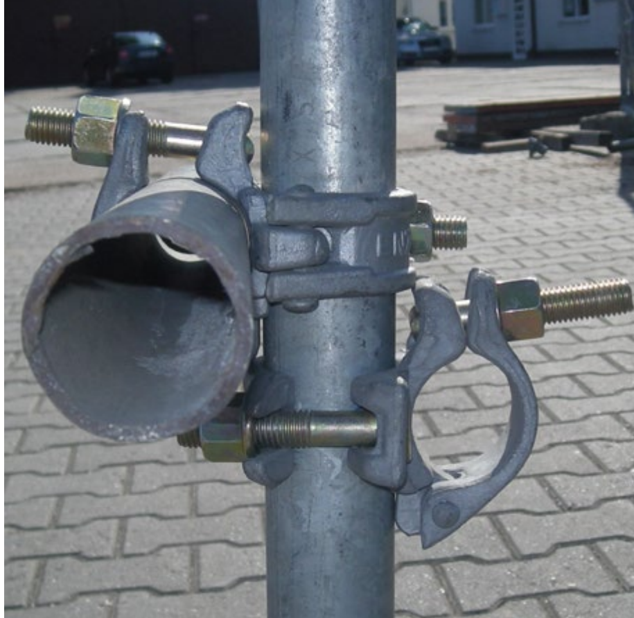
Obr. 2. Jak vytvořit sestavu pevných spojek v uspořádání AA+AA nebo BB+BB
